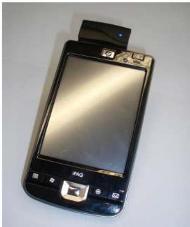
**Figura 2 Esempio di palmare con antenna Rfid**
